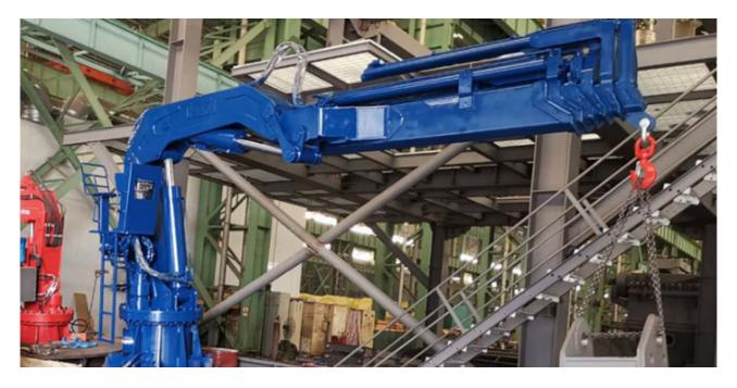
码头吊机在磨合期间容易出现的操作问题有哪些:零件脱落码头吊机的零件在长期的冲击和震动情况下,很容易发现松动,甚至是脱落的情况。另外一种情况则是在温度变化的情况下,零件受热比较大,也会发生变形或者松动。而一旦零件松动了,我们需要检测码头吊机是否有漏油的情况,以免出现安全隐患。操作错误新手在操作码头吊机的难免会因为紧张,或者是操作不顺手导致很多失误。浮式起重机会把比较庞大亦或者是比较重的东西,从一个地方转移到了两一个地方的机械设备。浮式起重机在很大的程度上其实也是要注意应该是需要有比较强的控制能力,来进行控制物体上的转移。
